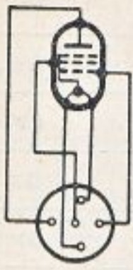
Patka O pro lampy : B 443, B 543, C 443, C 443N (Serie 250) E 443H, E 443N F 443N.
